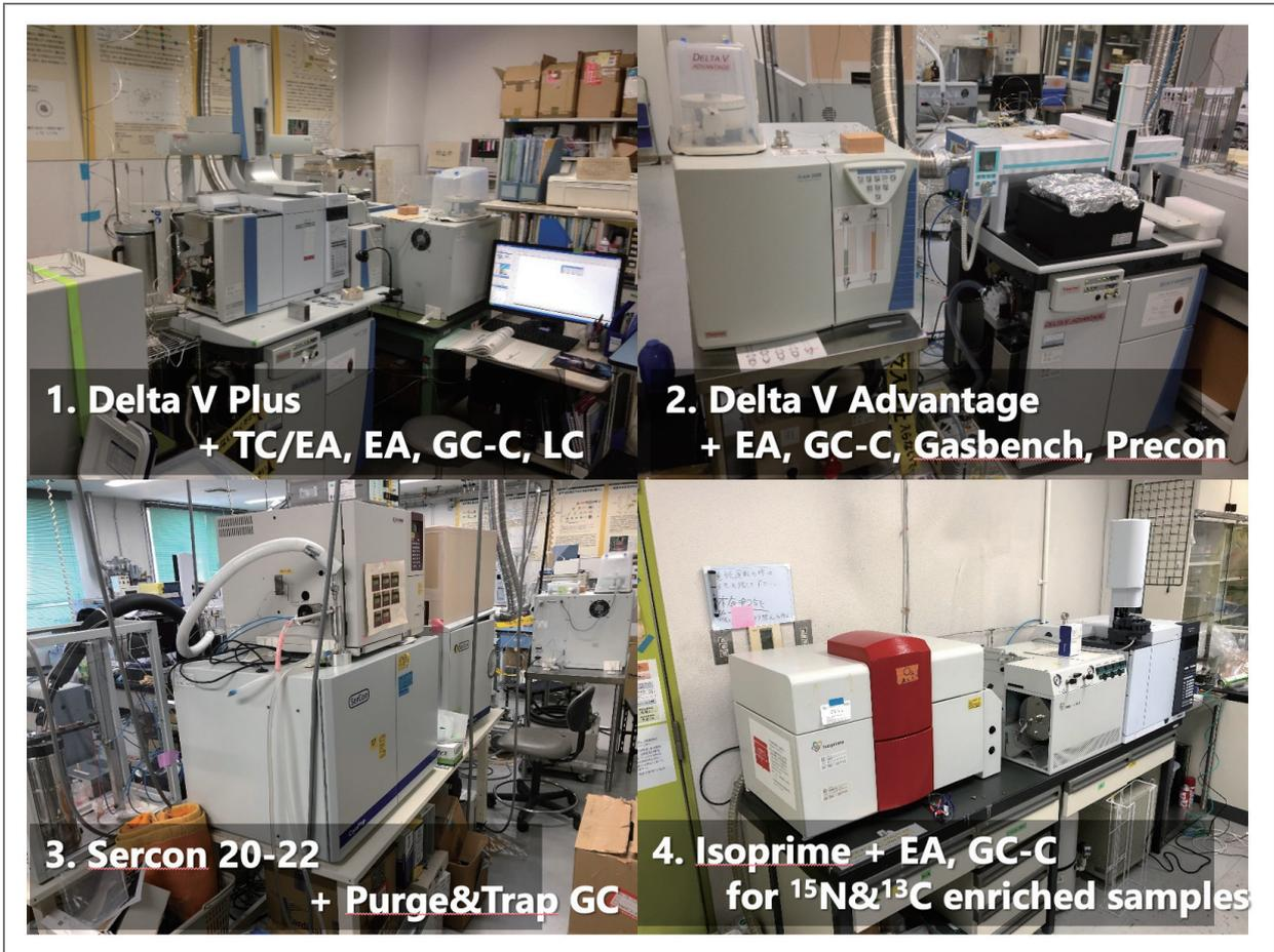
▲図1：現在のCER 安定同位体生態学測定装置群：2016年以降、微量窒素化合物専用機(3)、トレーサー測定専用機(4)を追加してきている
