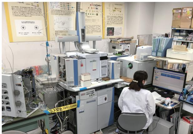
▲ 2010年3月に導入された、各種の前処理システムを備えた安定同位体比質量分析システム
